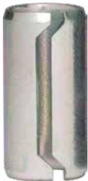
Las camisas se utilizan para posicionar los componentes junto con los tornillos, los cuales pasan por el interior de la camisa después de que se haya instalado. De este modo se elimina la necesidad de efectuar orificios extra para las clavijas posicionadoras. Las camisas templadas también absorben las cargas de corte, aislando de este modo a los tornillos de estas fuerzas.
