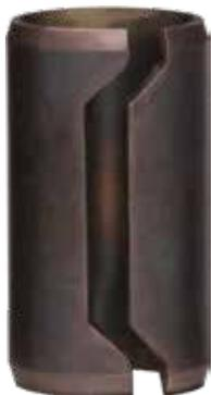
Las camisas de alineamiento de resorte se utilizan para situar con precisión los componentes uno con respecto al otro. Las camisas están fabricadas de forma cilíndrica para asegurar su redondez. Se recomienda que la mitad del orificio se utilice para el posicionamiento fijo del tornillo y la otra mitad para el orificio en la pieza de acoplamiento.
