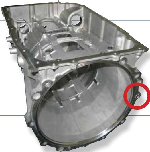
Un fabricante de equipos originales utilizaba un pasador de s lido de 16 mm de di metro exterior para ubicar la transmisi n en la parte trasera del motor. Esta aplicaci n en particular era m s exigente que el resto debido al peso de las dos piezas que deb an alinearse y al m todo utilizado para ensamblarlas. El cliente se acerc  a **SPIROL** en busca de sugerencias para reducir costos.
